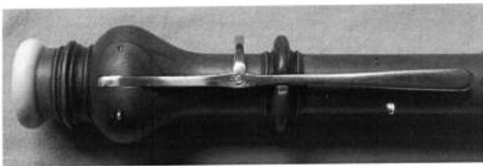
Aufgesetztes Holzteil nach dem farblichen Angleichen und Einpassen der neuen Oktavklappe
