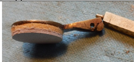
Angerissene e/h“- Klappe
