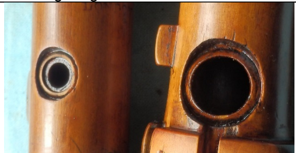
Ungleiche Tonloch- Anfräsungen an Ober- und Unterstück
