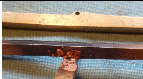
8 Ausgebrochene Achsenlagerung fis-cis“- Klappe verstärken
